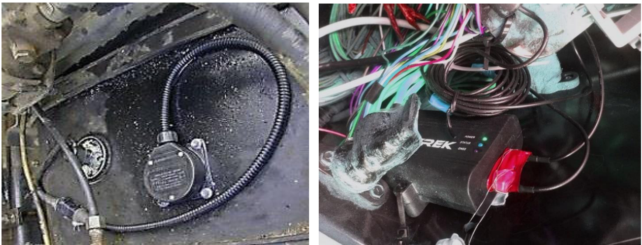
Рис 3.4. Монтаж приймально-передавального пристрою та датчика рівня палива на ТЗ
